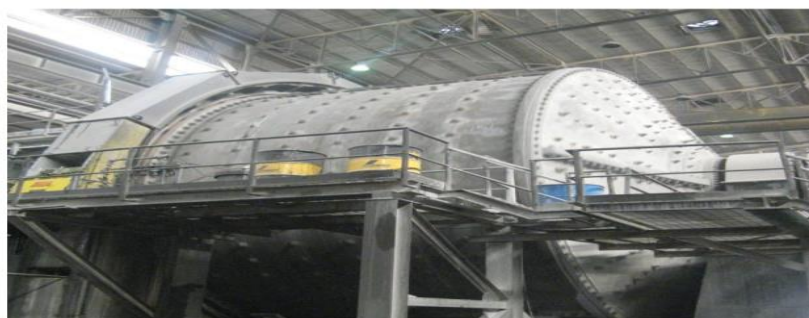
شکل ۵: نمایی از یک آسیای نیمه خودشکن
